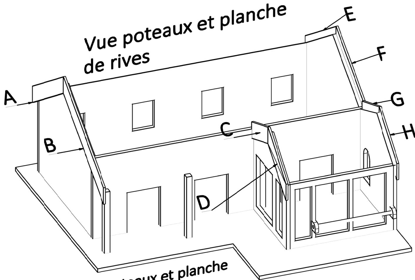
**Position des poteaux et planche de rives. Sur chaque côté du toit, véranda vient se rajouter des planches de rive de A à H.. Pour cachés les tuiles, (les bande de cartons).**
